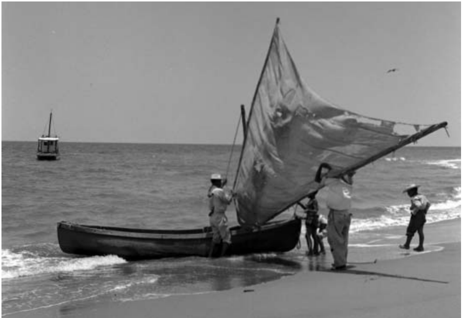
Fotografía 27. Embarcación de pescadores, hecha de huanacaxtle impulsada con vela.
