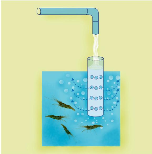
*Figura 14. Detalle de la porción terminal del sistema de llenado del estanque. La instalación de un tubo de PVC con huecos en sus paredes, de mayor diámetro que la tubería de conducción, favorece la oxigenación al introducir aire a presión dentro del agua. Esta adecuación es útil tanto para el llenado inicial como para los recambios programados.*
