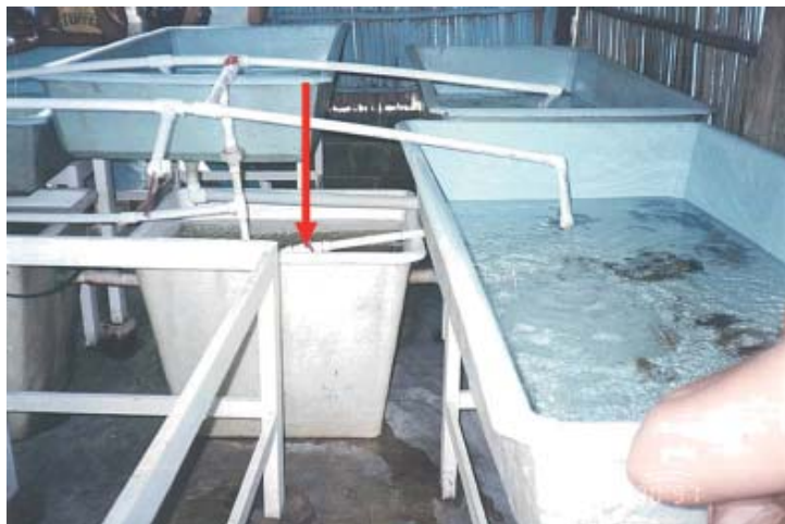
Imagen 14 Sistema de producción de jaiba suave de circulación cerrada con tanques de fibra de vidrio sobre soportes metálicos. El suministro de agua es por chorro y el drenaje a través del fondo en el centro del tanque. Nótese el sistema de tubería de PVC instalado para el suministro de agua. La flecha apunta al filtro biológico.
