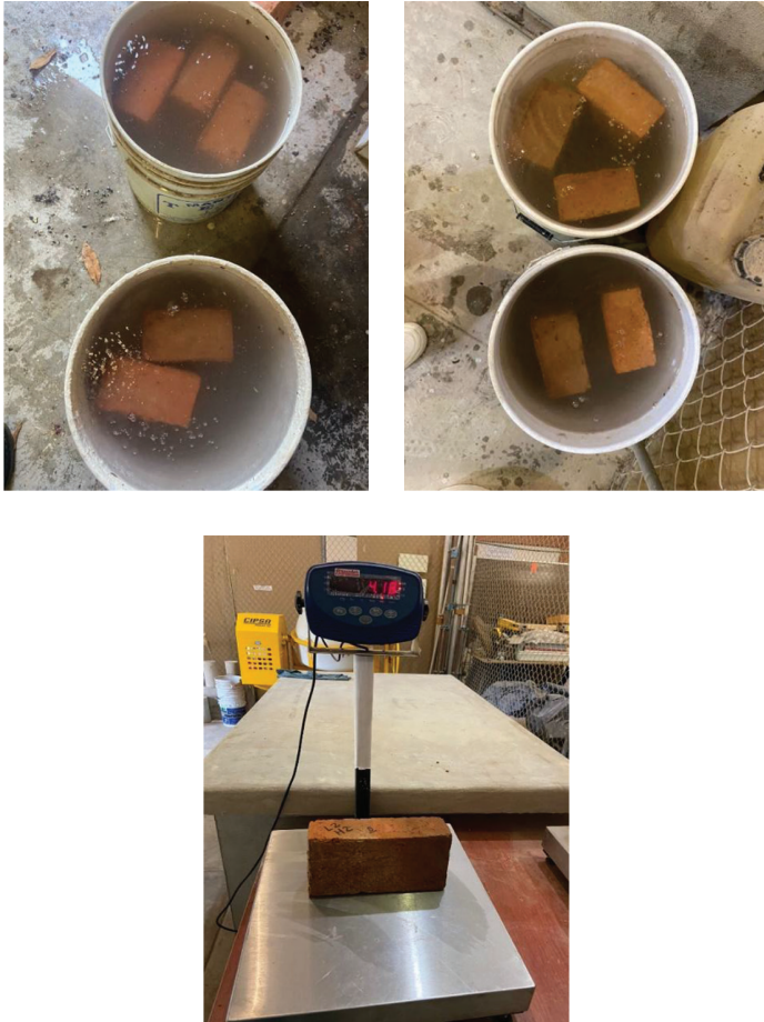
Figura 3. Absorción de humedad de especímenes
