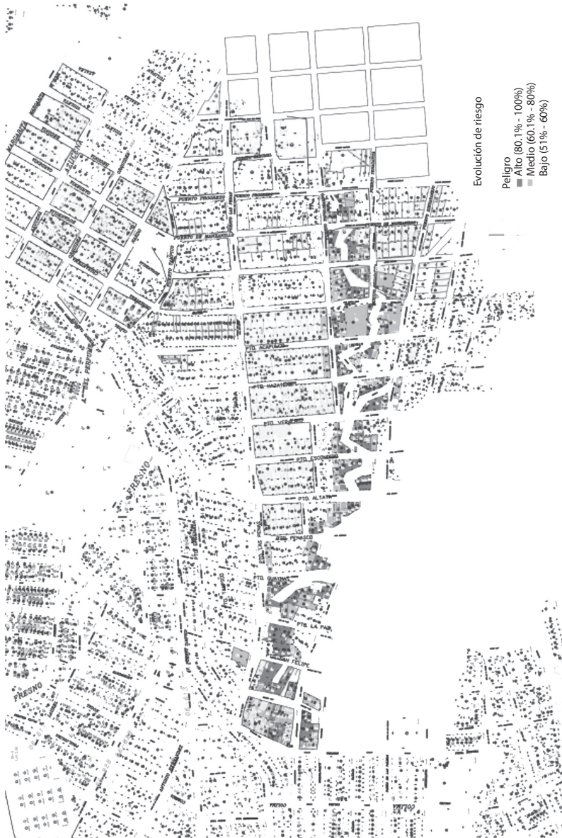
Figura I-6 Plano de vulnerabilidad por inundación de la colonia Ramblases
