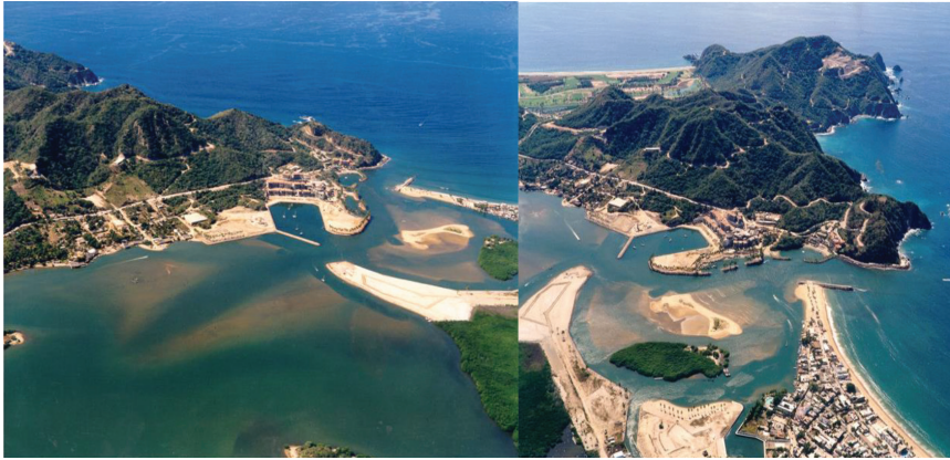
Figura 19. Transformación de la boca de la laguna de Barra de Navidad en marina y ampliación del proyecto (inicio de la etapa de azolvamiento del sistema durante la década de los ochenta). Fuente: Ramiro Flores Vargas.
