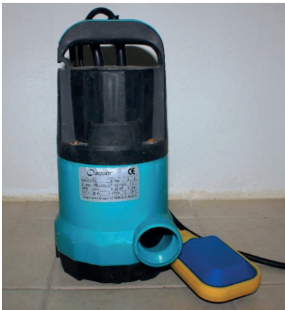
Fig. 9. Bomba sumergible con flotador para labores de mantenimiento.
