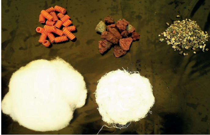
Fig. 15. Materiales filtrantes (de izquierda a derecha): tubo corrugado, tezontle, gravilla, guata y estopa.
