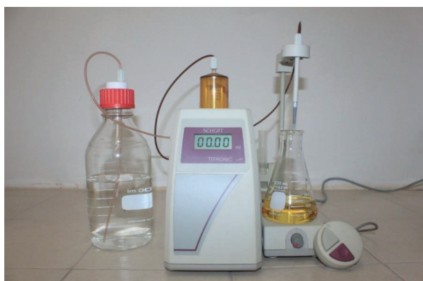
Fig.79. Titulador electrónico con muestra a la que, se añadió tiosulfato de sodio y adquirió un color amarillo paja.
