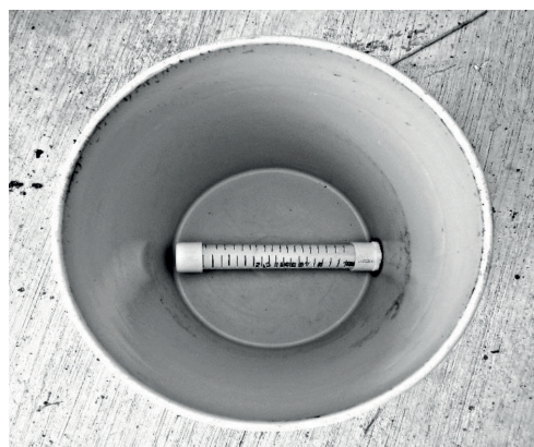
Fig. 14. Interior de la cubeta. Tubo perforado para evitar taponamientos.
