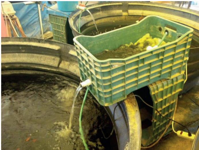
Fig. 16. Biofiltro terminado y en funcionamiento (como contenedor se utilizó una caja plástica rectangular de 80 L).
