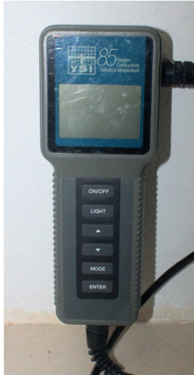
Fig. 76. Oxímetro YSI 85 para medir oxígeno, conductividad, salinidad y temperatura.
