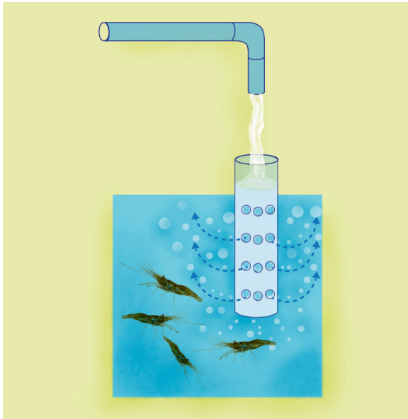
Figura 14. Detalle de la porción terminal del sistema de llenado del estanque. La instalación de un tubo de PVC con huecos en sus paredes, de mayor diámetro que la tubería de conducción, favorece la oxigenación al introducir aire a presión dentro del agua. Esta adecuación es útil tanto para el llenado inicial como para los recambios programados.
